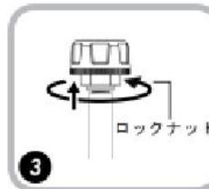
、タイヤセンサーをタイヤバルブにしっかり締め付けた後、ロックナットをの取り付け時とは逆方向に、特殊レンチを使用して締め上げ、タイヤセンサーを固定します
